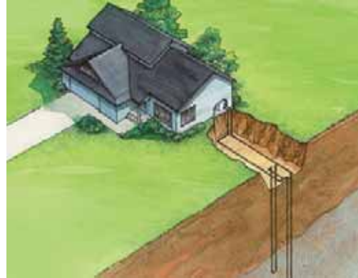
Σχήμα 3.39. Γεωεναλλάκτης κλειστού κατακόρυφου κυκλώματος (“τυφλές” γεωτρήσεις).
