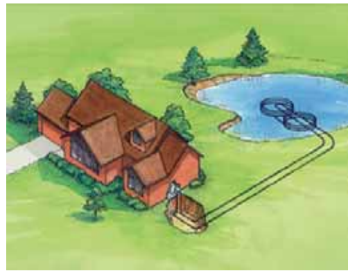
Σχήμα 3.41. Σύστημα αντλίας θερμότητας με εκμετάλλευση της θερμότητας του νερού λίμνης.
