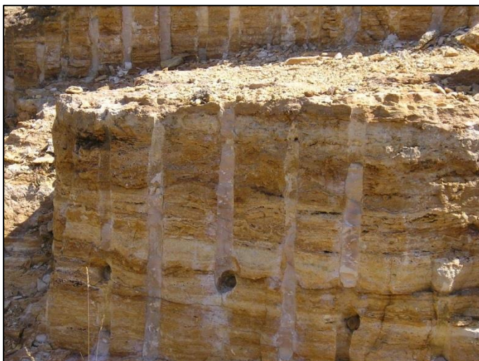
Obr. 2.9-2. Těžba bloků kokorského travertinu. Srpen 2005. Foto: JiZi.
