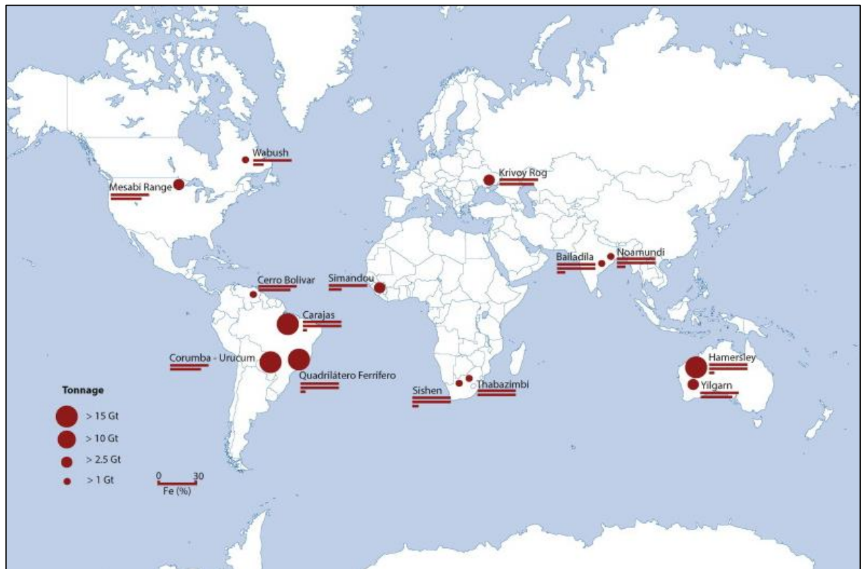
Obr. 3.1-3. Pozice významných revírů a ložisek rud typu BIF s vyznačením velikosti zásob. Kumulativní délka červené linie pod názvem každé lokality vyjadřuje obsah Fe v rudě.
