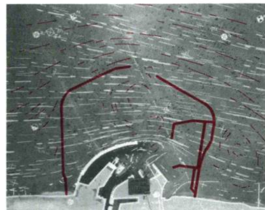
Fotografische opname van stroombanen en -snelheden door middel van oppervlakte drijvers Wit = voor de voorhavenuitbouw Rood = na de voorhavenuitbouw
