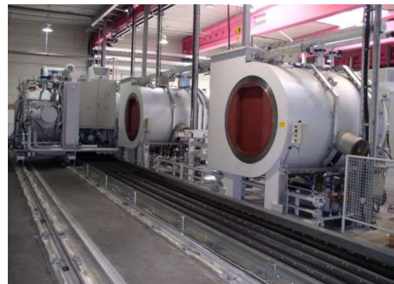
Automatisierte Linie zum Niederdruckaufkohlen
