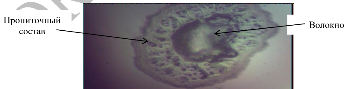
Рис. 1. Поперечный срез обработанного полиэфирного волокна, х400
