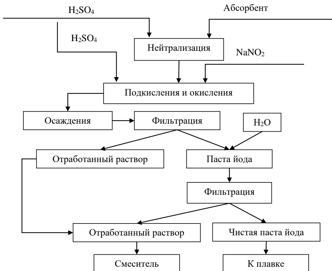
Рис. Принципиальная схема осаждения элементарного йода из абсорбента
