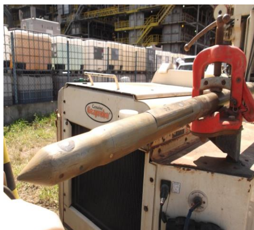
Figura 4. Ponteira do MIP em preparação para o ensaio.
