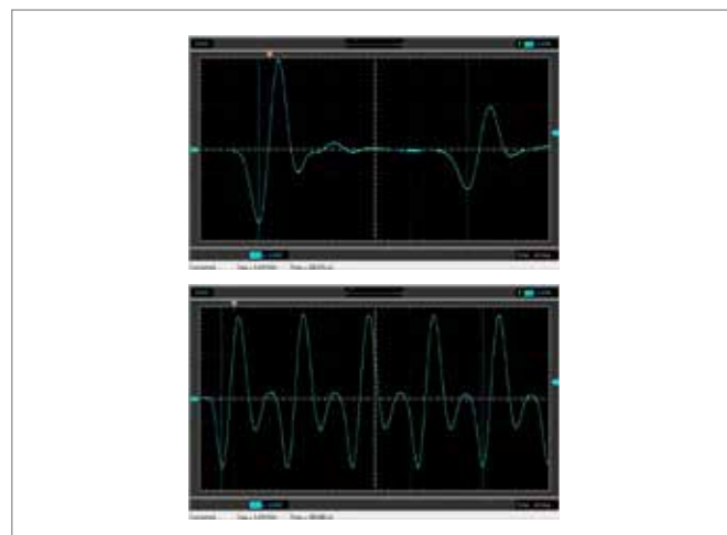
Fig. 3: Propagazione dell'impulso sonoro in un'asta in PVC lunga 200 mm (sopra) e un'asta in vetro lunga 200 mm (sotto). Segnale della sonda microfono presso l'estremità dell'asta opposta a quella eccitata.
