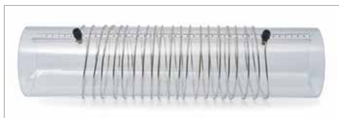
Fig. 1: Bobina con densità di spire variabile
