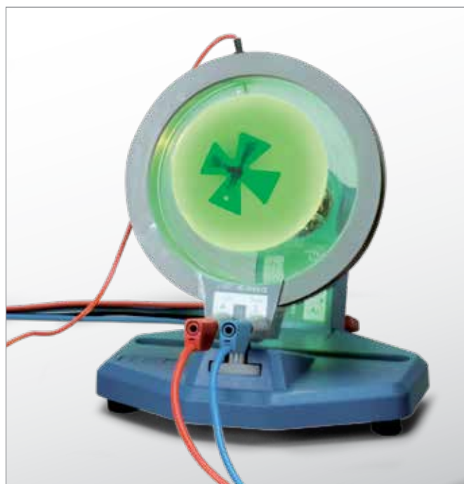
Fig. 2: Rotazione dell'ombra degli elettroni tramite deflessione degli elettroni nel campo magnetico
