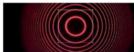
Fig. 2: Nessun campo magnetico esterno: Osservazione degli anelli di interferenza della riga di cadmio rossa creata dall'interferometro di Fabry-Pérot. Come supporto di orientamento, il secondo anello di interferenza dal centro è indicato con un riquadro.
