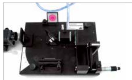
Camera evacuabile sul percorso dei raggi dell'interferometro di Michelson
