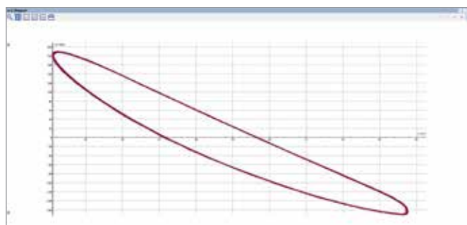
Fig. 1: Diagramma p - V del motore Stirling G
