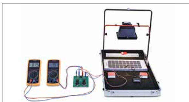
Dipendenza dalla temperatura della potenza dei moduli solari
