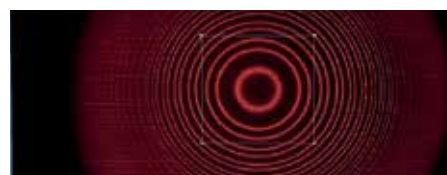
Fig.3.: Effetto Zeeman longitudinale: Osservazione della scissione in doppietti della riga di cadmio rossa in un campo magnetico esterno.
