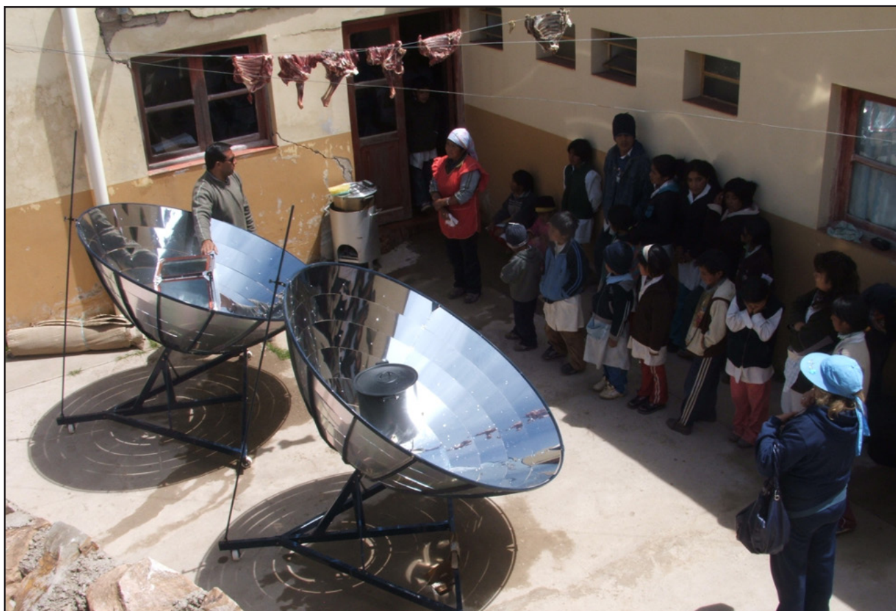
Figura 2: Dos cocinas solares para escuelas albergue.
