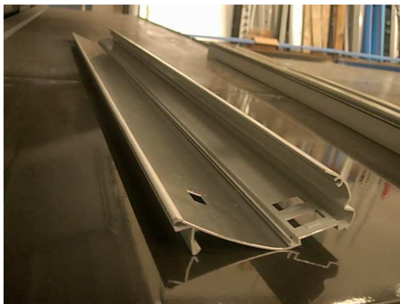
Fig 34. Reflector en plástico con superficie reflectante en aluminio (CVD).
