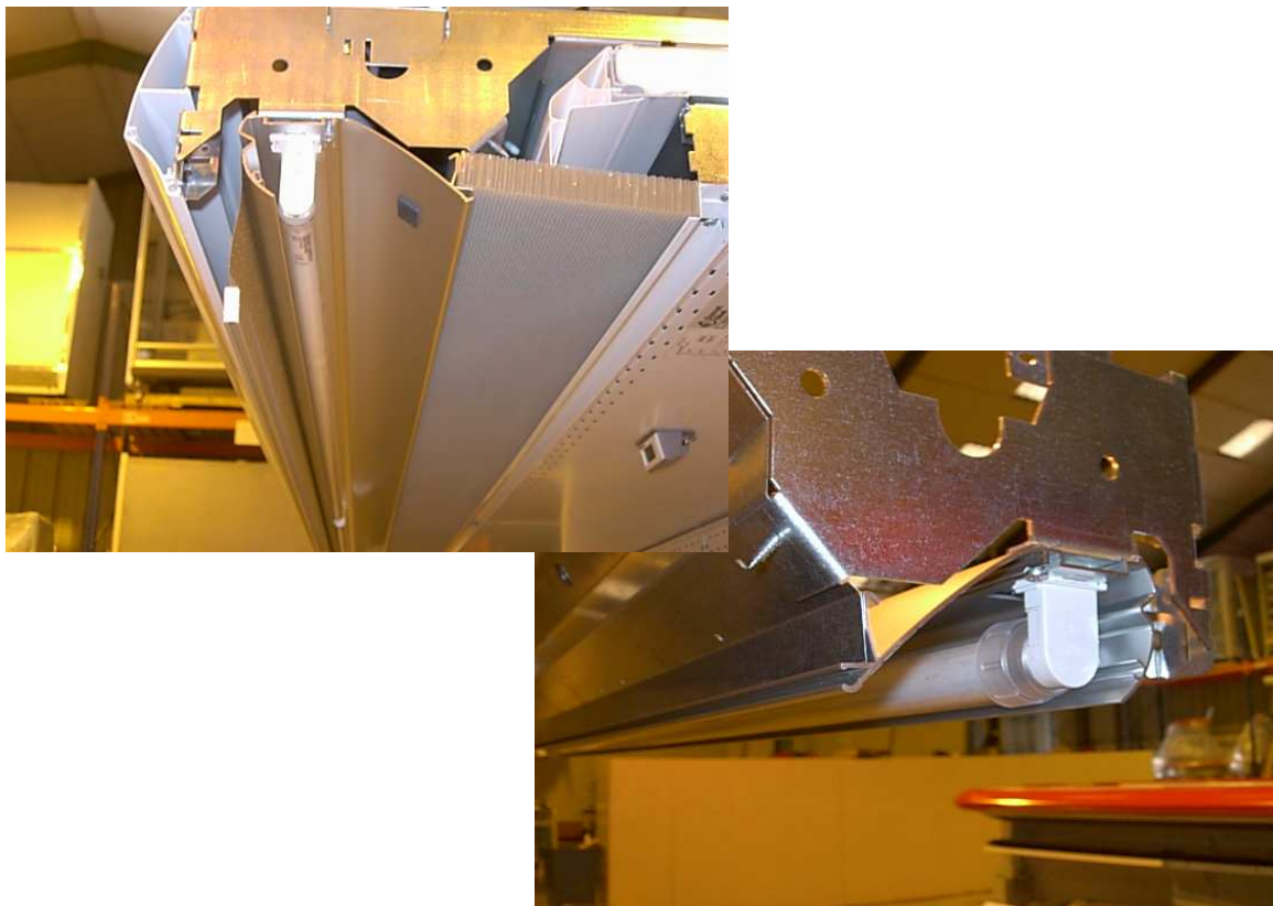
Fig 5. Sistema iluminación actual por delante y por detrás.
