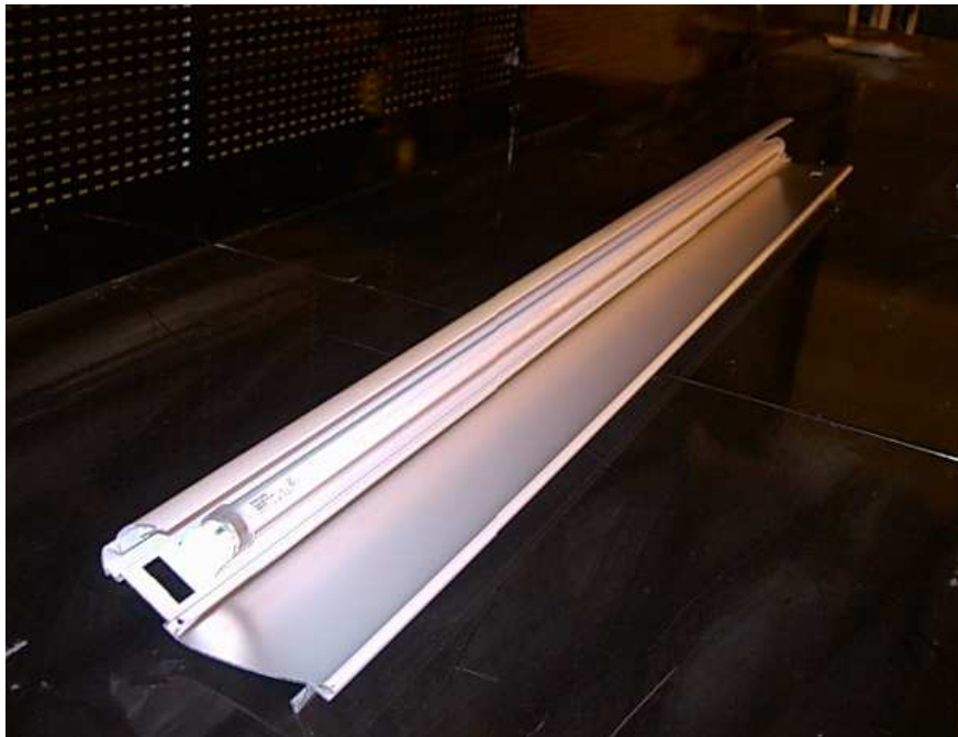
Fig 20. Prototipo reflector plástico + reflectante.
