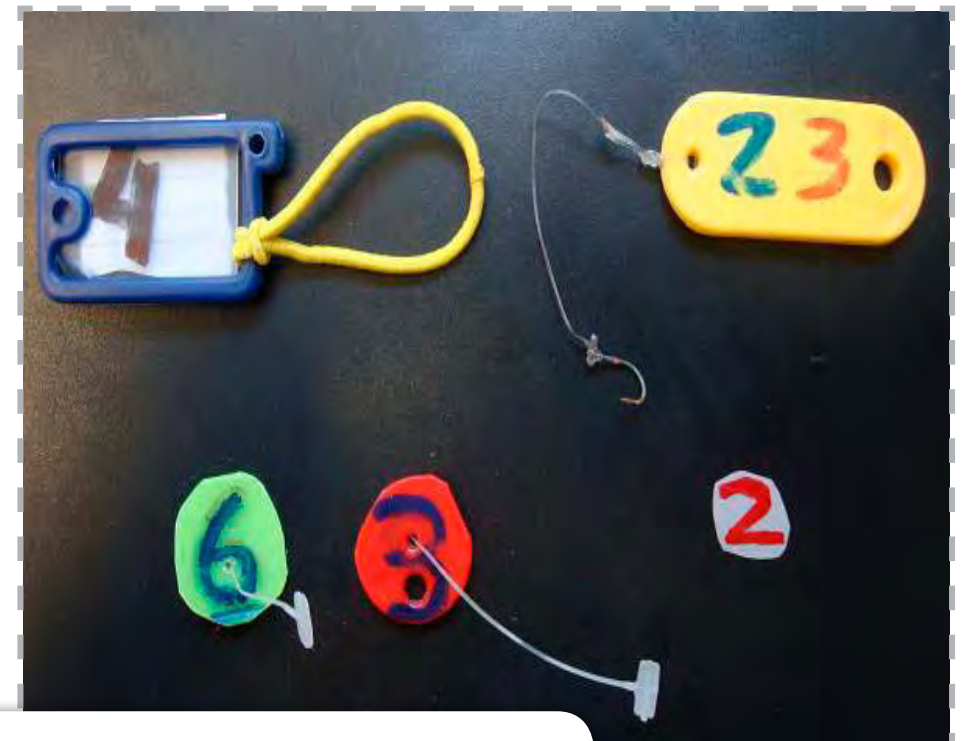
FIG. 1. DIFERENTES TIPOS DE MARCAS (DE ARRIBA ABAJO Y DE IZQUIERDA A DERECHA): A) ELÁSTICO, B) ANZUELO, C) T-BAR CORTO, D) T-BAR LARGO Y E) PLACA CON PEGAMENTO.
