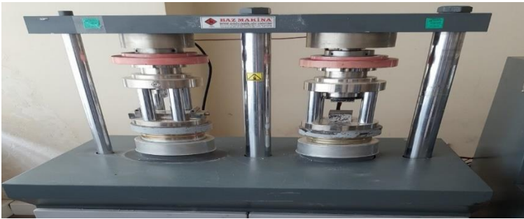
Şekil 17. Eğilme-Basınç deney düzeneği
