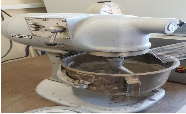
Şekil 13. Sıva harçlarının hazırlandığı karıştırma cihazı
