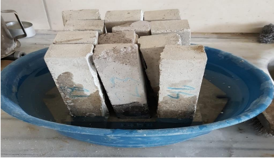
Şekil 18. Kılcal su emme deneyi için hazırlanan düzenek
