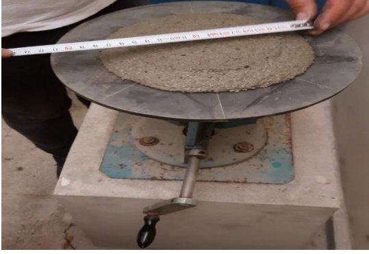
Şekil 16. Sıva harçlarına uygulanan yayılma deneyi
