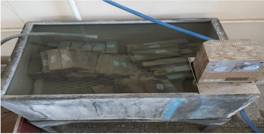
Şekil 15. Harç numunelerin bekletildiği kür havuzu
