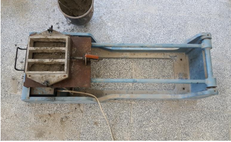
Şekil 14. Sarsma tablası ile prizmatik numune kalıbı
