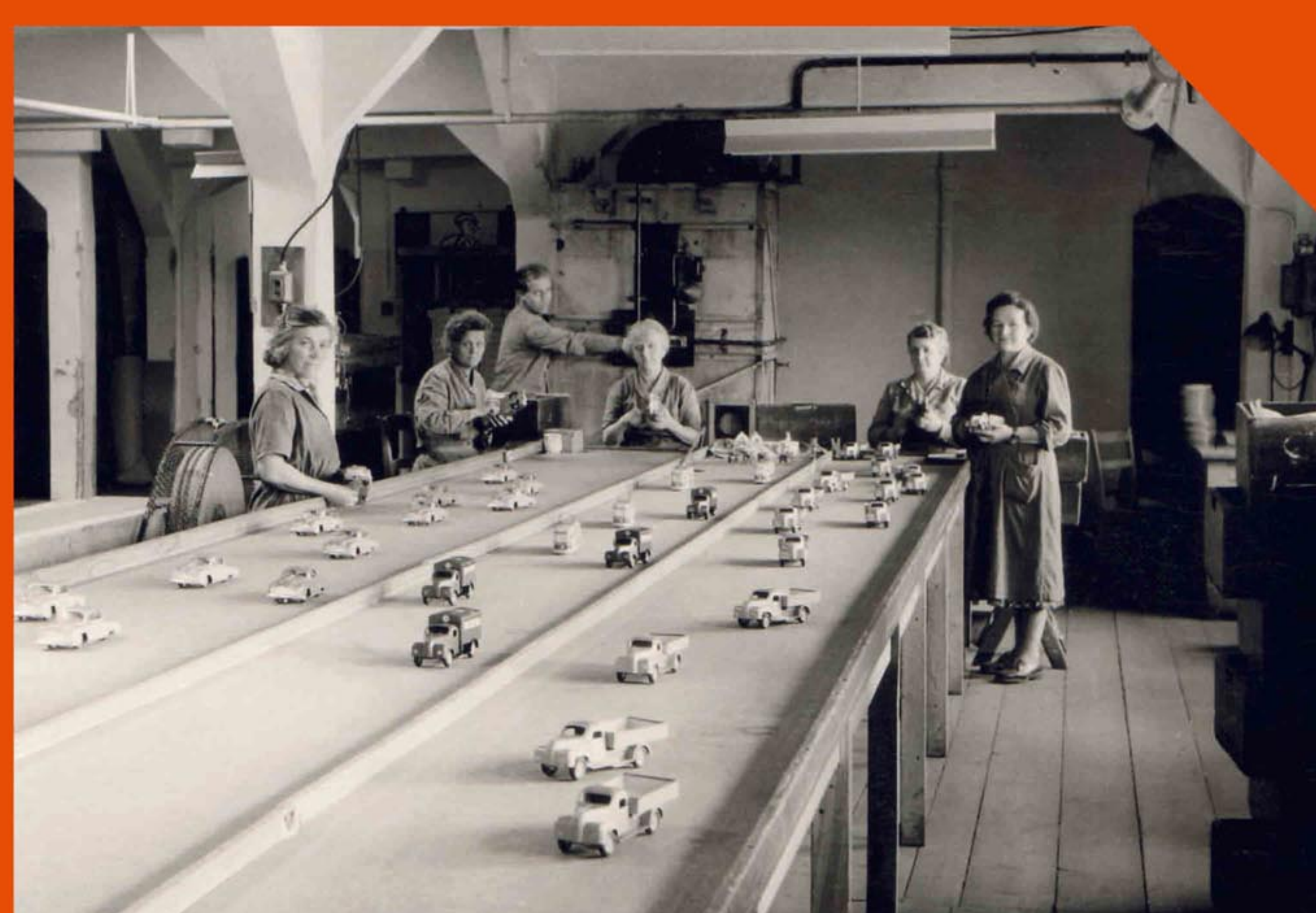
Federwerkskontrolle an Spielzeugautos, mit Fahrerhaus aus Bakelit, 1950er Jahre. Quelle: Stadtmuseum Brandenburg an der Havel
