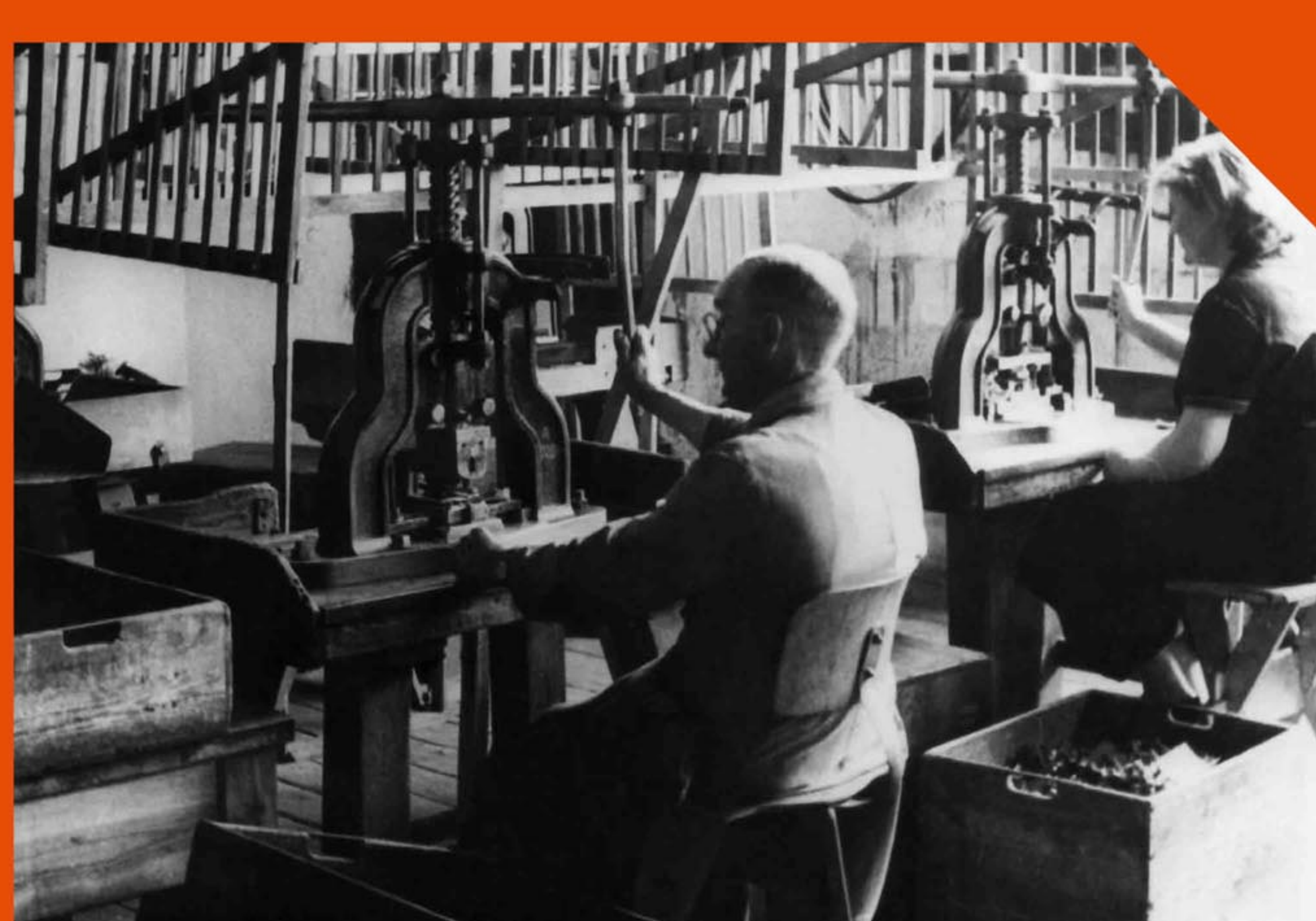
Ausstanzen von Blechteilen mit Handspindelpressen, 1950. Quelle: Stadtmuseum Brandenburg an der Havel
