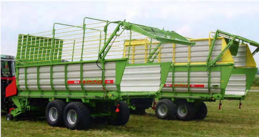
AGRAR BISON und LEON Ladewagen bieten wir Ihnen auch mit einem leistungsfähigen Dosieraggregat an. Die Antriebskupplung liegt direkt auf der Hauptantriebswelle. So ist der gesamte Antriebsstrang nur beim Abladen in Betrieb. Die Dosiereinheit verfügt über eine programmierbare SPS-Steuerung.
