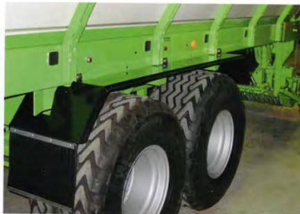
Mit der gefederten Bogie-Tandemachse werden Unebenheiten auf Strassen wirkungsvoll gedämpft – für schnelle Strassenfahrten und lange Transportwege das ideale Fahrwerk.
