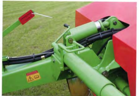
Auf Wunsch ist eine hydraulische Knickdeichsel lieferbar. Ein gross dimensionierter Hydraulikzylinder erlaubt eine stufenlose Höhenverstellung. Bei den grösseren Ladewagen kommen 2 Zylinder zum Einsatz.
