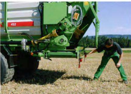
Das optional lieferbare Querförderband wird hydraulisch über eine Bordhydraulik angetrieben. Zum Abladen im Fahrsilo lässt sich das Querförderband bequem unter die Ladebrücke schieben.
