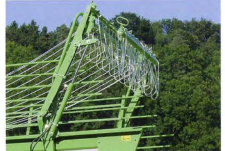
Die Seitüre ist einfach zu bedienen und ermöglicht von hinten einen freien Zugang zur Ladebrücke. Als Option ist eine hydraulische Betätigung lieferbar.
