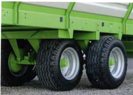
Bei der AGRAR Doppelachse sind die Fahrspuren versetzt, der Achsabstand beträgt nur 670 mm. Nebst der guten Gewichtsverteilung ist die Achse auch für enge Kurvenfahrten sehr gut geeignet.
