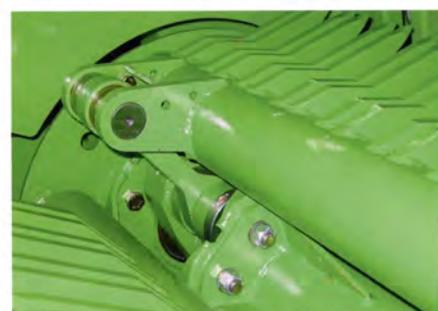
In der Leistungsklasse der BISON Ladewagen haben wir auf eine Kurvenbahnsteuerung verzichtet und diese durch eine solide Lenkersteuerung ersetzt.
