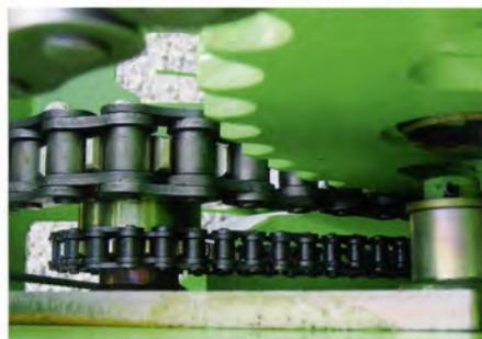
Der Pickup-Antrieb wurde mit einem zweifach gelagerten Umlenkrolle konstruiert. So können wir Ihnen auch unter erschwerten Bedingungen, bei Einwirkung von Schmutz und Steinen, eine hohe Betriebssicherheit garantieren.
