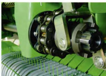
Die Leistungsübertragung zum Rotor erfolgt über eine massive Antriebswelle aus hochlegiertem Vergütungsstahl. Die gehärtete Kupplung mit Profilverzahnung ist grosszügig dimensioniert.
