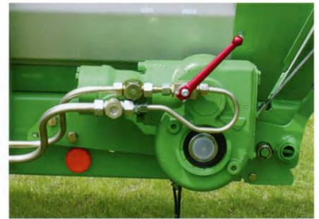
Der Kratzbodenantrieb erfolgt hydraulisch mit einem Untersetzungsgetriebe. Der Antriebsmotor ist direkt am Ölbadgetriebe montiert.
