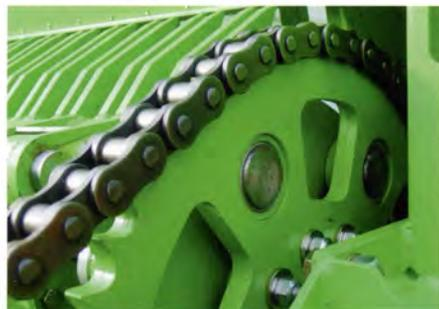
Eine hochbelastbare 1½" Rollenkette mit automatischer Kettenspannung übernimmt den Rotorantrieb. Auf Wunsch ist eine automatische Kettenschmierung lieferbar.
