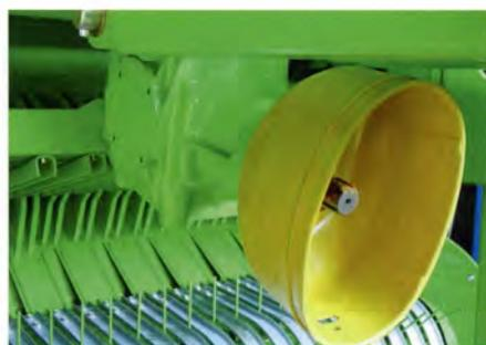
Der Kraftfluss ab dem Traktor erfolgt über ein robustes Kegelradgetriebe mit doppelter Lagerung. Eingangsdrehzahl beim BISON 540 min<sup>-1</sup>; beim LEON 1000 min<sup>-1</sup>.
