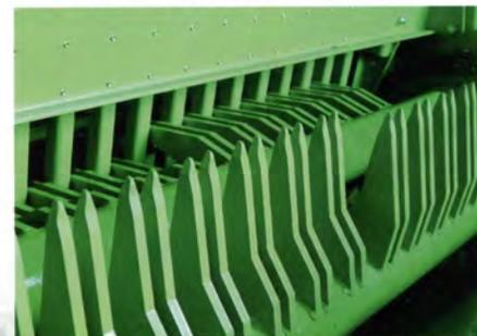
Die Förder- und Schneidebenen sind zweistufig angeordnet. Die Schwingen sind beidseitig aussen gelagert, direkt dort, wo die Antriebskraft der 1 1/2" Kette eingeleitet wird.
