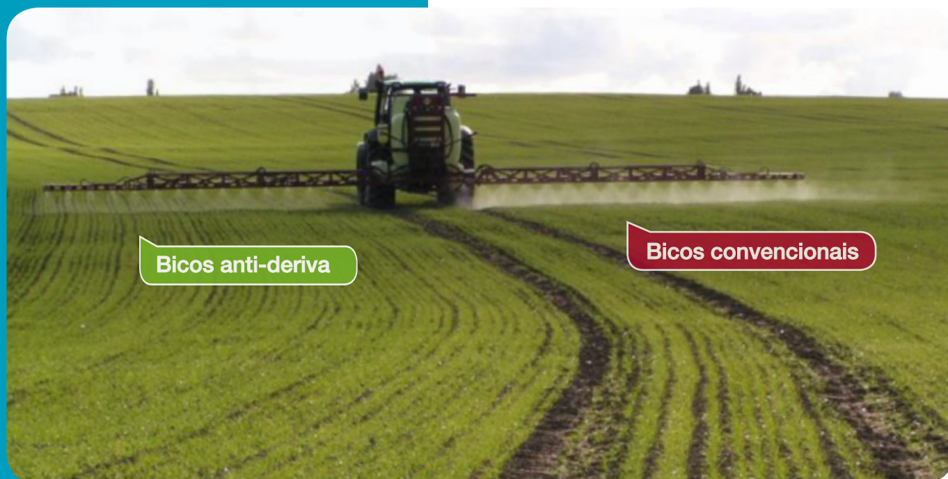
Figura 2. Pulverizador de barra equipado com bicos anti-deriva (lado esquerdo) e bicos convencionais (lado direito)
