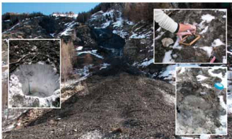
Fig. 2 - Deposito di neve nella zona di accumulo principale della valanga (LDA): evento del 2009. Sulla destra un particolare del metodo di campionamento della superficie del deposito (sopra) e della parte interna (sotto); a sinistra la buca scavata nel deposito fino al suolo.
