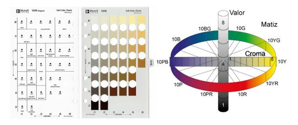
Figura 5. Esquema de avaliação das cores do solo, com base na Carta de Cores Munsell para Solos (Munsell Soil Color Charts, 1994).
