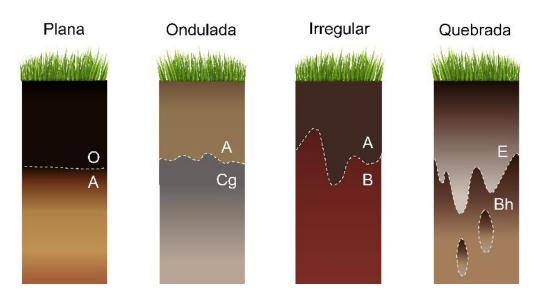
Figura 4. Tipos de transição entre horizontes do solo, quanto à topografia.
