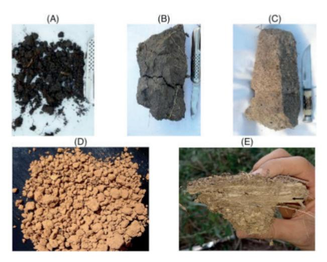
Figura 8. Tipos de estrutura quanto a forma. (A) Granular; (B) prismática que se desfaz em blocos angulares. (C) colunar; (D) blocos subangulares e; (E) laminar. Fotos: Marcos Gervasio Pereira e Sérgio Hideite Shimizu.
