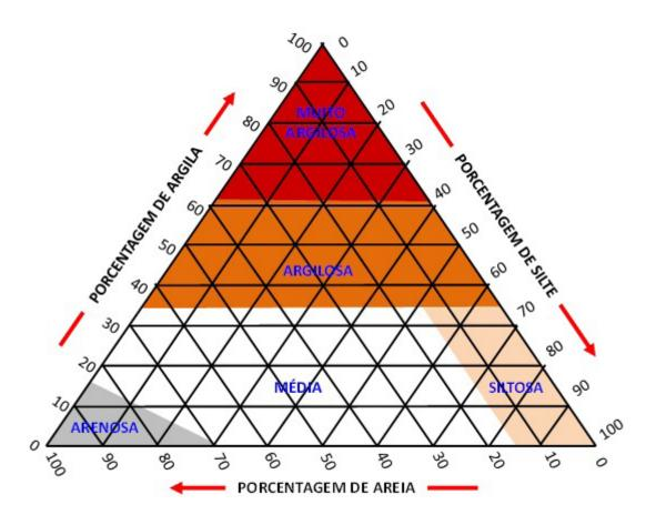
Figura 7. Triângulo textural para determinação da classe textural.
