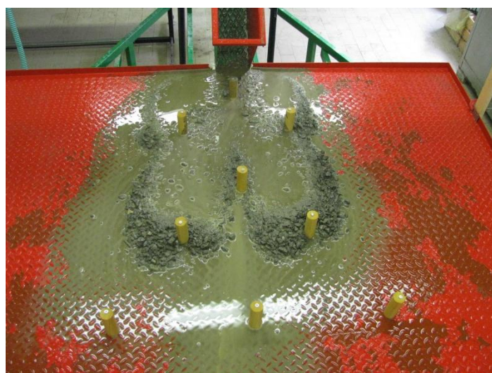
Figura 49: lobo di deposizione di colata con elementi da 35 mm di diametro e spaziatura 20X20cm
