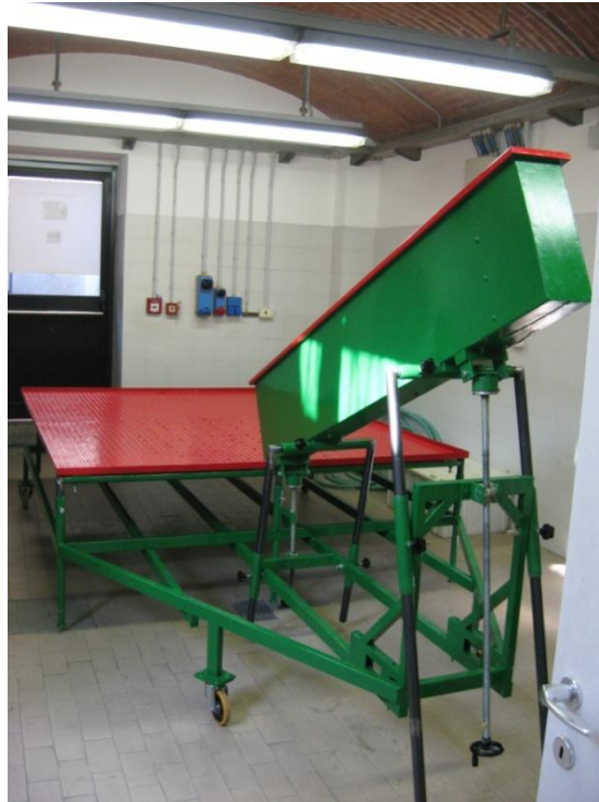
Figura 18: reometro del Dipartimento di Ingegneria Agraria, sezione di Idraulica: si può notare in primo piano la canaletta inclinabile con il sistema di regolazione della pendenza, ed in secondo piano il bancone in cui si realizza il deposito.
