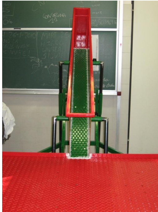
Figura 19: vista frontale della canaletta nella configurazione con fondo scabro.
