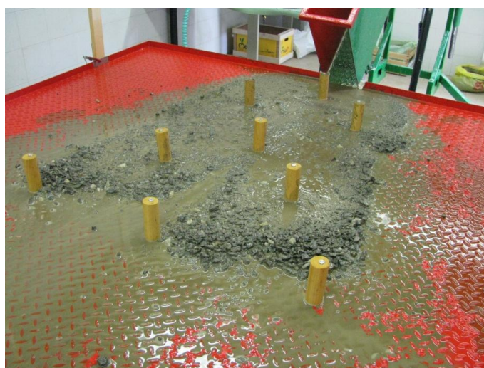
Figura 48: Prova eseguita con elementi di diametro 35 mm e spaziatura 20X20 cm.
