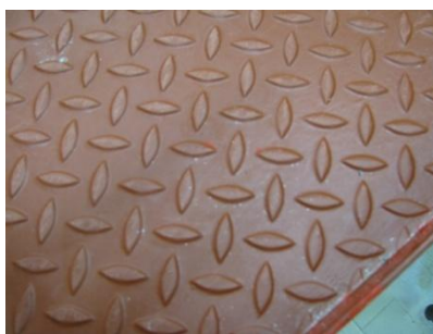
Figura 24: particolare del piano sul quale si realizza il deposito del materiale delle simulazioni: lo spessore degli elementi di scabrezza è pari a 2 mm, la dimensione è di 10 mm nel punto più largo e 25 mm nel punto più lungo.
