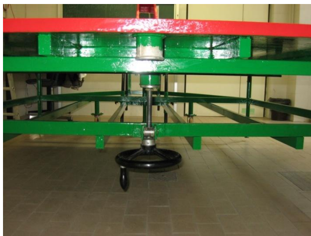
Figura 23: sistema di regolazione della pendenza del piano di deposito nella parte distale rispetto il cambio di pendenza, e scarico delle acque di lavaggio.
