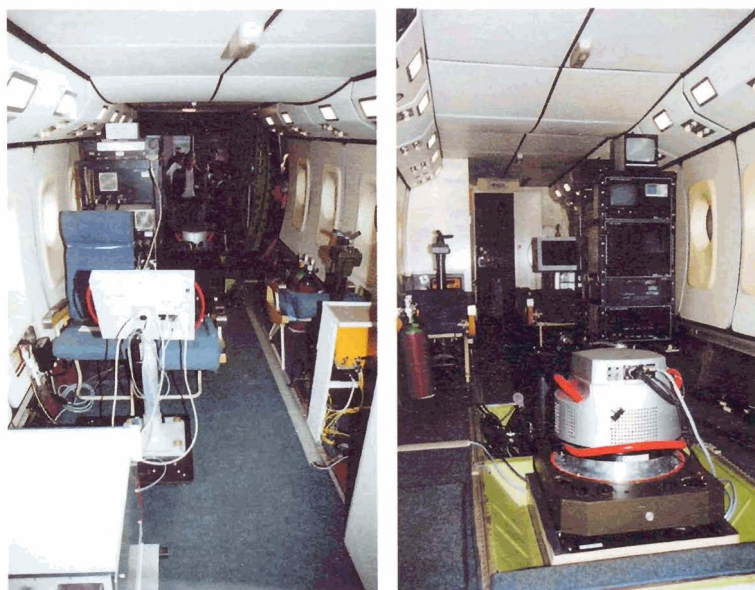
Particolari dell'ampia cabina del laboratorio aereo in cui sono visibili il MIVIS, la camera fotogrammetrica digitale ADS40 della LH Systems e il sistema D-GPS.
