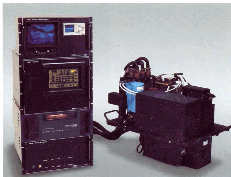
I vari componenti del MIVIS: a sinistra l'elettronica di controllo e a destra la testa di scansione.
