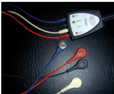
Figura 5. Los terminales de los electrodos poseen un dispositivo que nos indica la polaridad de los cables.
