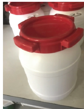
Bild 1-19: Probenahmebehälter für Zement
