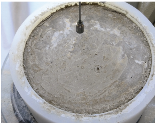
Bild 1-12: Prüfen des Erstarrungsendes (Rückseite)
