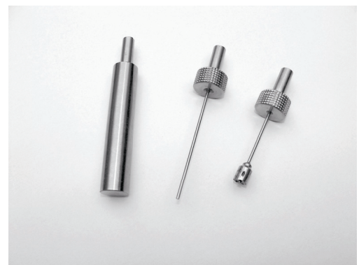
Bild 1-02: Tauchstab für Konsistenz, Prüfnadeln für Erstarrungsbeginn, Erstarrungsende
