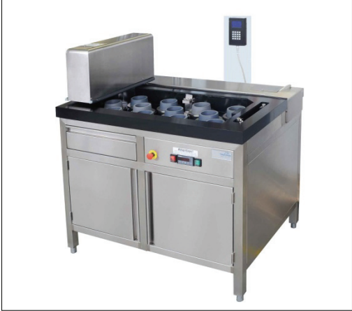
Bild 1-14: Alternatives computergesteuertes mehrstelliges Vicat-Gerät
