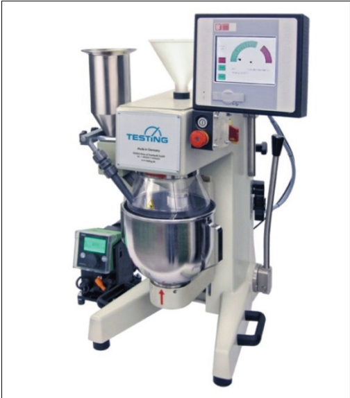
Bild 1-15: Standard-Mörtelmischer mit zusätzlicher Konsistenzmessung
