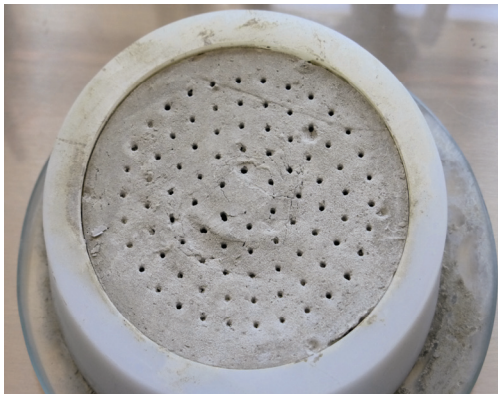
Bild 1-11: Typisches Eindringverhalten bei der Bestimmung des Erstarrungsbeginns (Vorderseite)
