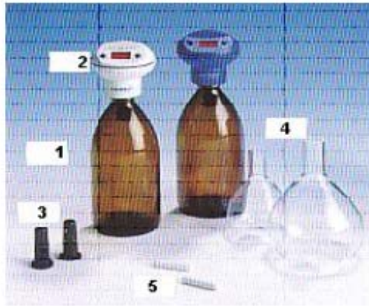
Εικόνα 7.2.6.1 : Ειδικός εξοπλισμός για την μέτρηση του BOD. Μπουκάλια (1), κεφαλές-ψηφιακοί αισθητήρες (2), θήκες από καουτσούκ (3), ογκομετρική φιάλη υπερχειλίσης όγκου 428 ml (4) μαγνητικές ράβδοι ανάδευσης (5).
