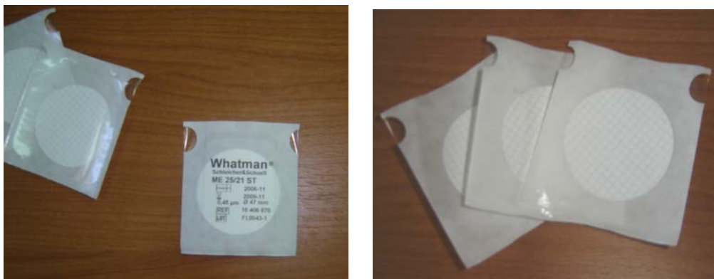
Εικόνες 7.2.14.3 α,β : ηθμοί κυταρρίνης με μέγεθος ανοίγματος 0,45 \mu\text{m} (Whatman)
