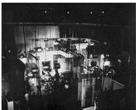
Στούντιο έγχρωμης τηλεόρασης. Τα φώτα και οι οθόνες που κρέμονται από το ταβάνι αφήνουν περισσότερο χώρο ελεύθερο για να κινηθεί το συνεργείο.
