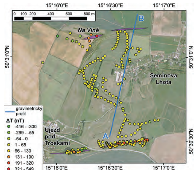
Obr. 5. Magnetická měření a interpretovaný tvar těles mezi Semínovou Lhotou a Újezdem pod Troskami (zdroj ortofotomapy je www.cenia.cz). A-B – linie gravimetrického profilu přes kruhovou deprese.
