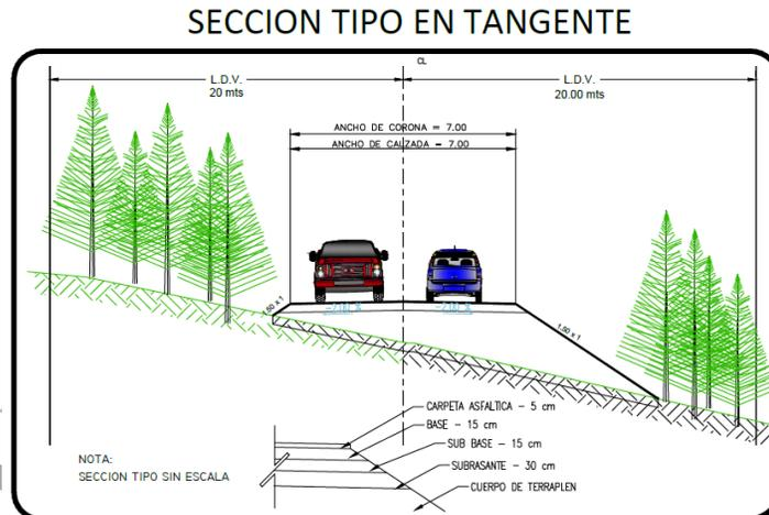
Figura II.8. Sección tipo y línea de ceros.
