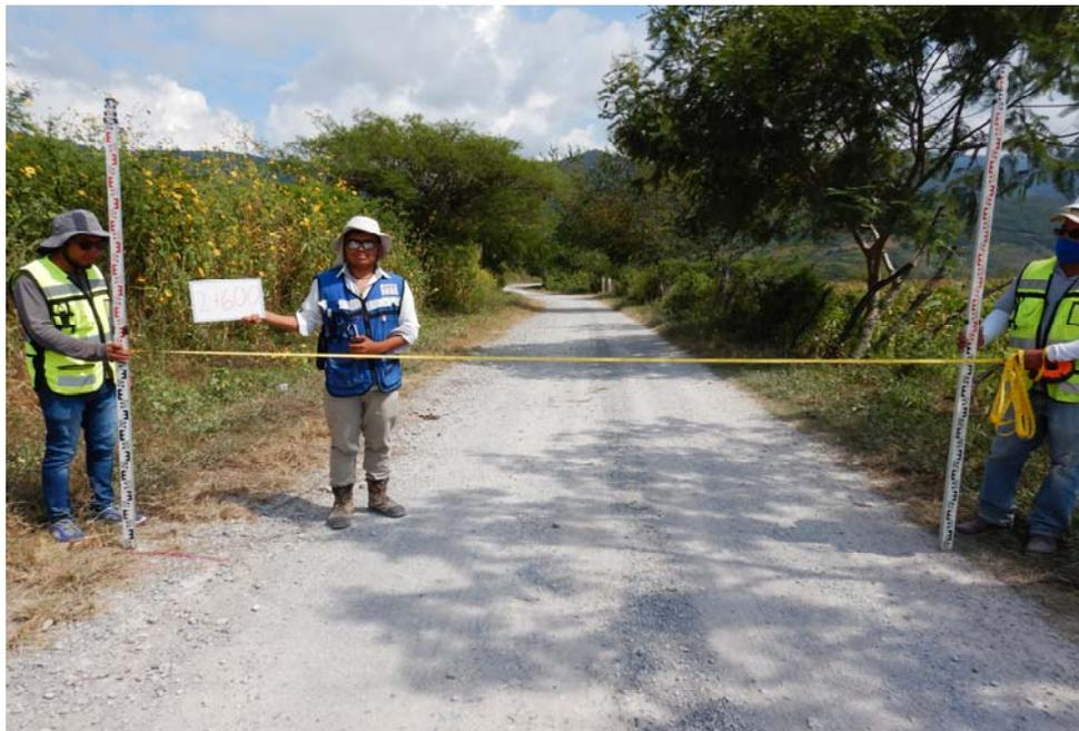
**Fotografía 14.-** Se puede apreciar el ancho del camino de 9.0 m en el Km 2+600.
