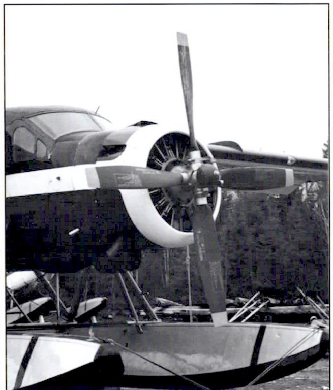
Un des Otter de Air Saguenay équipé du moteur polonais PZL de 1000 forces.
