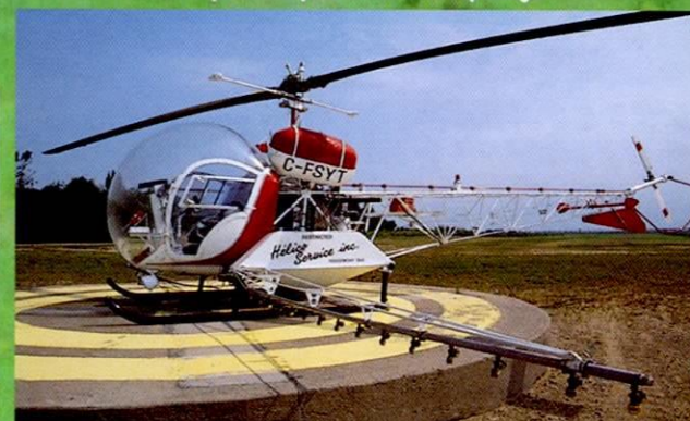
Les hélicoptères et les avions sont munis d'un équipement particulier pour effectuer de l'épandage.
