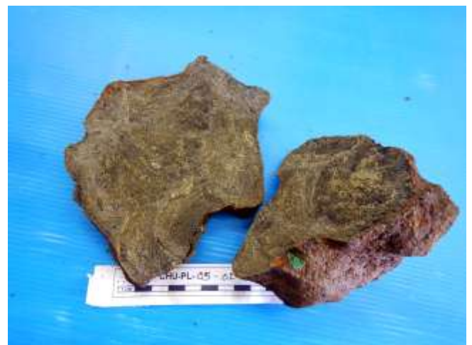
Sulfure semi-massif prélevé dans le talus à la base du flange actif (CHU-PL-01-01)
