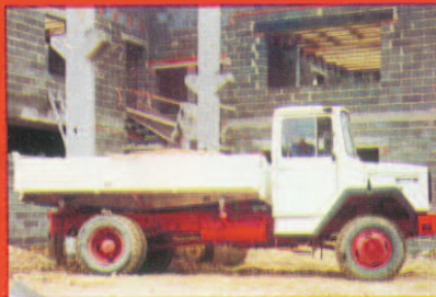
Typ: 120D 12AK Motor: 120 PS 6 Zyl.-Reihe Nutzlast: 6 600 kg Gesamtgewicht: 12300 kg
