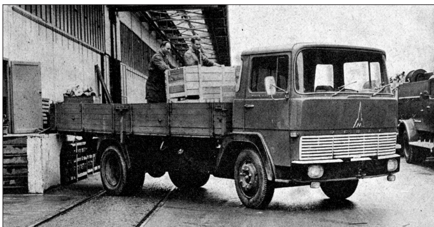
Deutz 1965: 90 D 7 FL, 7450 kg GG, 4 t Nutzlast
