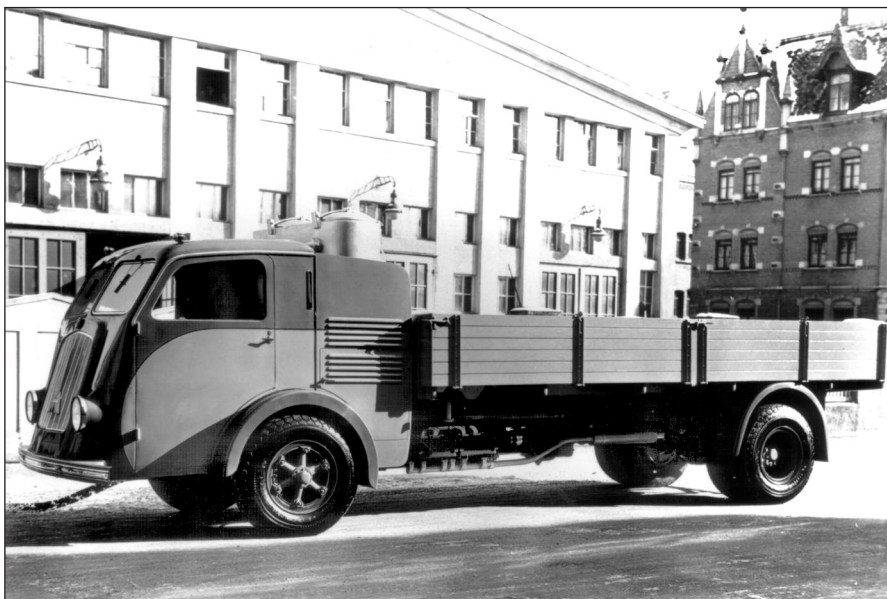
Magirus 1935: mit Anthrazitvergaser und 150-PS-Zwölfzylinder-Mittelmotor
