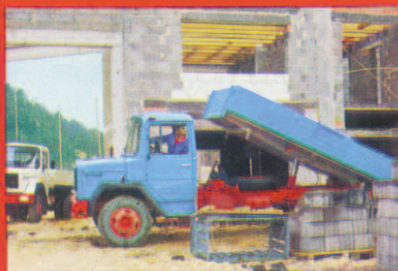
Typ: 120D 12K Motor: 120PS 6 Zyl.-Reihe Nutzlast: 7 050 kg* Gesamtgewicht: 12300 kg
