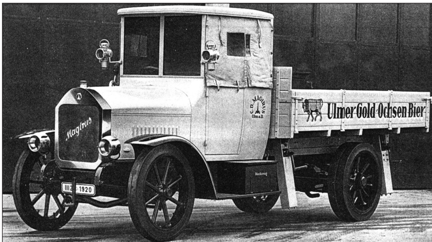
Magirus-Zweitonner 2 C – V 110 von 1920 als Zweiseitenkipper 1
