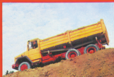
Typ: 232D 22AK 6x6 Motor: 232 PS 8 Zyl.-UV Nutzlast: 12 200 kg Gesamtgewicht: 22000 kg
