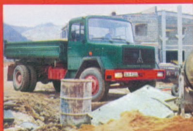
Typ: 170D 15K Motor: 176 PS 6 Zyl.-V Nutzlast: 8 350 kg* Gesamtgewicht: 15000 kg
