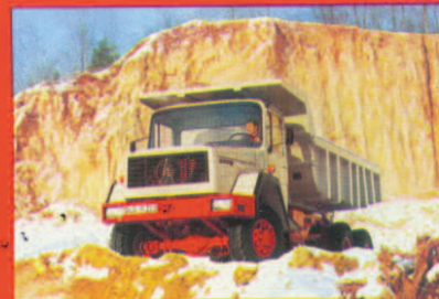
Typ: 232D 26AK 6x6 Kipper/Mulde Motor: 232 PS 8 Zyl.-V Nutzlast: 14 800/14 000 kg Gesamtgewicht: 26000 kg
