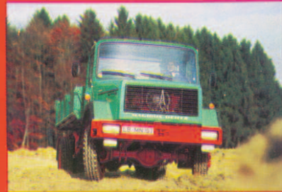
Typ: 170D 12AK Motor: 176 PS 6 Zyl.-V Nutzlast: 6 100 kg* Gesamtgewicht: 12300 kg
