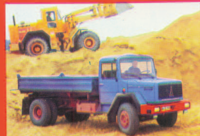
Typ: 232D 16K Motor: 232 PS 8 Zyl.-V Nutzlast: 8 600 kg* Gesamtgewicht: 16000 kg
