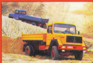
Typ: 170D 15AK Motor: 176 PS 6 Zyl.-V Nutzlast: 7 850 kg Gesamtgewicht: 15000 kg
