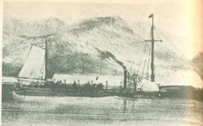
Puede afirmarse que la era de la navegación a vapor la inició Roberto Fulton. El grabado reproduce a su barco "Clermont" surcando el río Hudson, impulsado por una rueda de palas, que a su vez era accionada por un motor de vapor. El ingeniero norteamericano alcanzó rápida celebridad y fue aclamado como héroe nacional.
