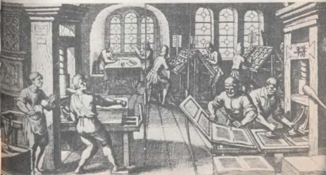
El grabado reproduce un taller de imprenta del siglo XVI. A la derecha el "tornillo", que al bajar la plancha permite imprimir por presión.
