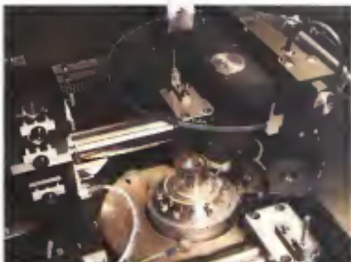
Questo è il meccanismo che genera il master in vetro usando il laser in basso nella foto per generare dati premasterizzati.
