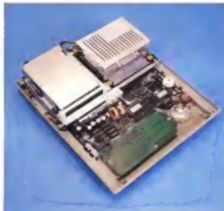
Il suo layout della macchina appena aperto e, qui a destra, in questa conformazione: l'hard e l'elettronica di base + controller per il display oltre al modem e l'alimentatore.
