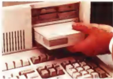
un back-up di 40 Mbyte avviene in meno di 5 minuti. La versione più piccola di Passport (1.25") viene usata con una procedura di carico e scarico simile a quella usata per i videoregistratori.
