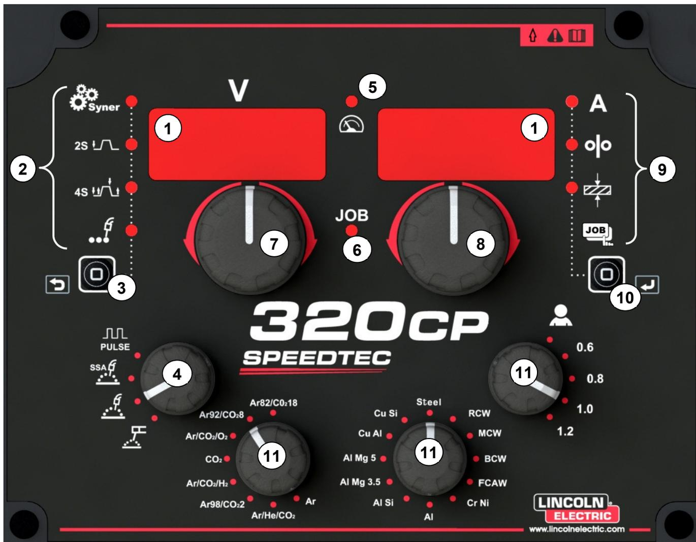
Linke Anzeige: Spannung, Rechte Anzeige: Strom/ Drahtgeschwindigkeit / Drahtdicke
