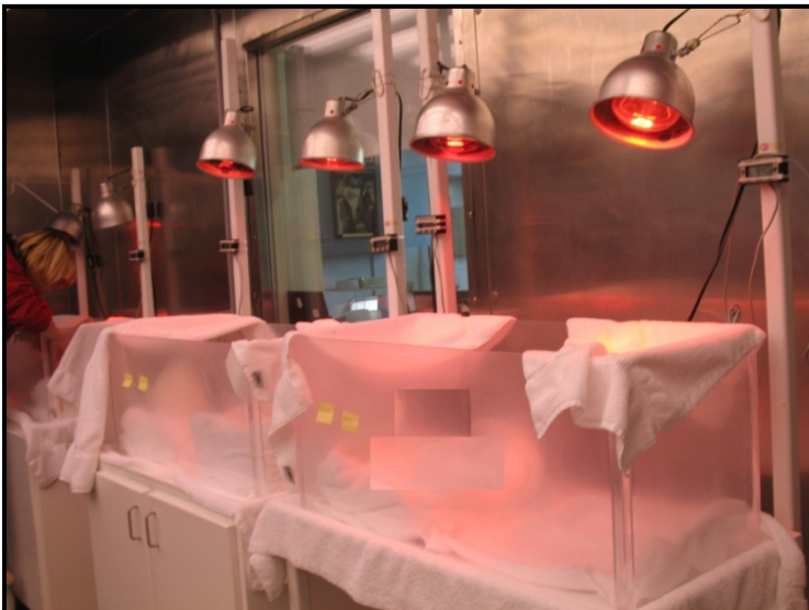
Figura 14. Una vista más cercana de las cajas criadoras de Plexiglas®. Note las toallas al interior. Lecturas digitales están montadas en cada poste vertical con sondas de temperatura que se extiende en criadoras. Foto cortesía de Linda Henry
