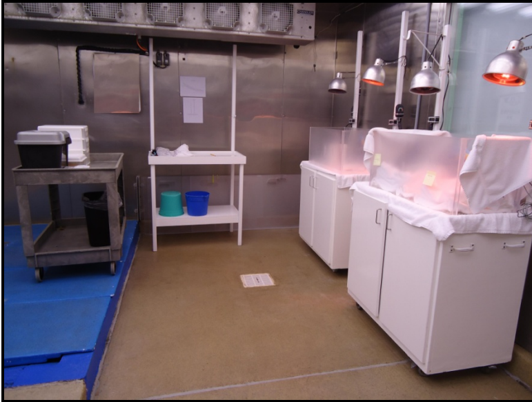
Figura 13. Dos cajas criadoras de Plexiglas® establecidas en la parte superior con lámparas de calor aseguradas. Las toallas cubren uno o ambos lados para controlar el flujo de aire. Note los ventiladores en la esquina superior izquierda; estos proporcionan enfriamiento y buena circulación de aire. Es importante que la habitación se enfríe para compensar la producción de calor por las lámparas. La iluminación es proporcionada por un conjunto de bombillas fluorescentes regulables de 40W. El fotoperíodo durante el período neonatal se establece para que coincida con los parámetros del exhibidor. Foto cortesía de Linda Henry.
