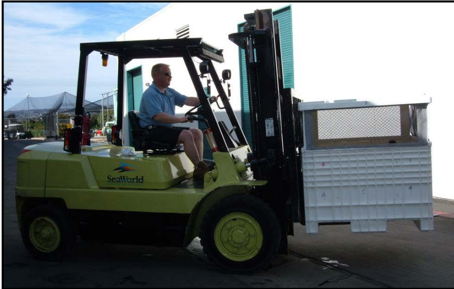
Figura 2. Los contenedores deben tener ranuras integradas en ellos para que un montacargas lo pueda mover con facilidad. Fotografía cortesía de Lauren DuBois
