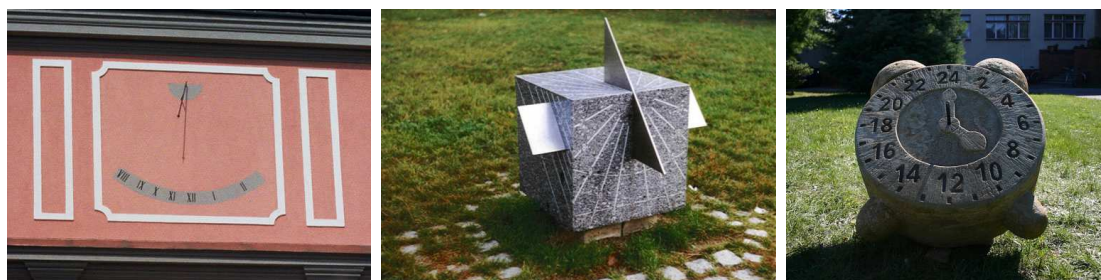
Obrázek 72: Svislé (vertikální) sluneční hodiny ze zámku ve Valašském Meziříčí (vlevo), vodorovné (horizontální) před Hvězdárnou a planetáriem Brno na Kraví hoře a rovníkové z Hvězdárny a planetária v Hradci Králové [E38].
