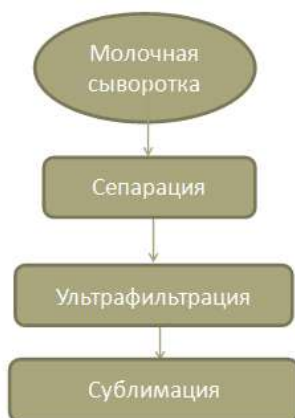
Рисунок 4 – Технологическая схема получения природного ангиогенина
