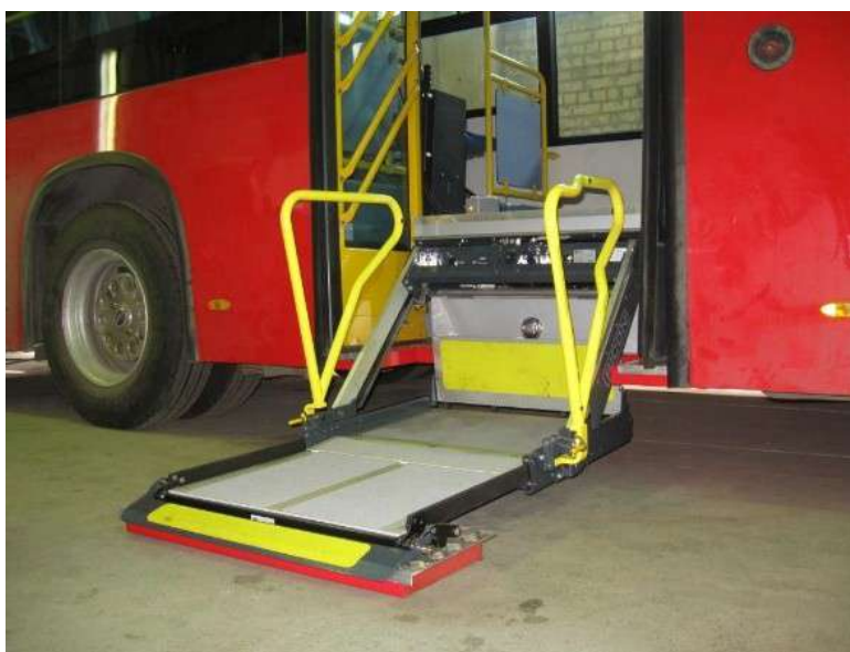
Рисунок 5 – Пример подъемной площадки для автобуса
