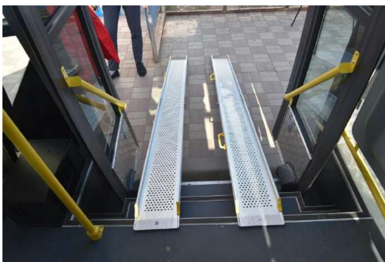
Рисунок 4 – Пример выносного пандуса в общественном транспорте
