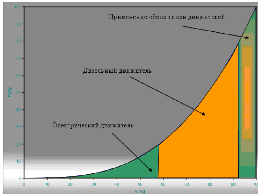
Рисунок 2 – Допустимые границы применения электрического, дизельного и дизель-электрического типов движителей
