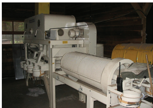
Foto 7 - Máquina limpiadora y clasificadora de semillas. Campo Forestal San Martín, El Bolsón, EEA INTA Bariloche.
