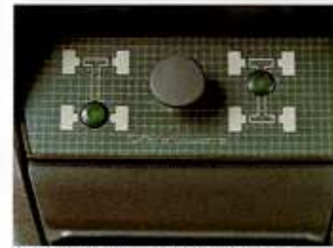
Kontrollampen und Zugknopf für zuschaltbare Differentialsperren.
