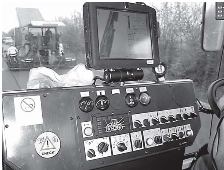
Bild 1: Walzenführerkabine mit Displays zur Anzeige des Verdichtungszustands der Asphaltfläche
