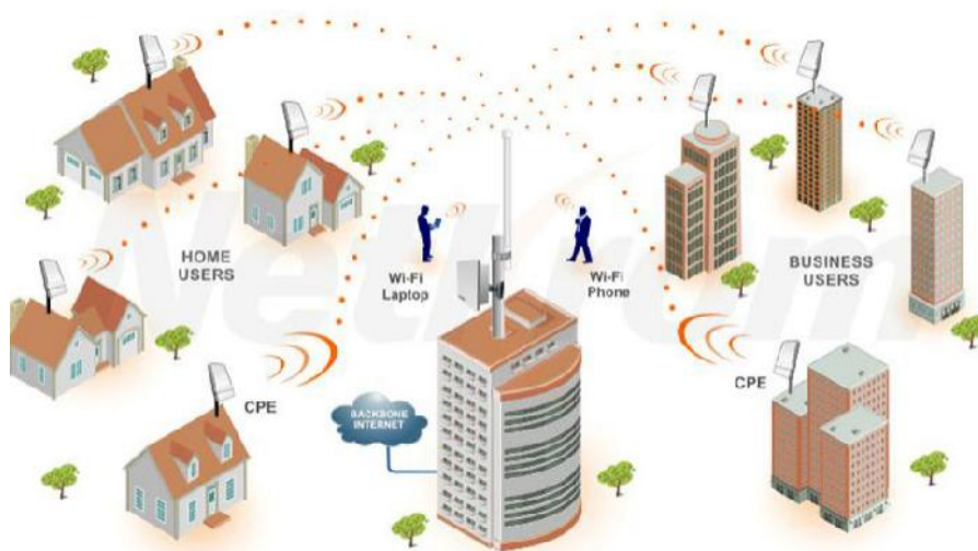
Figura 1.8. Infraestructura General de un WISP [19]
