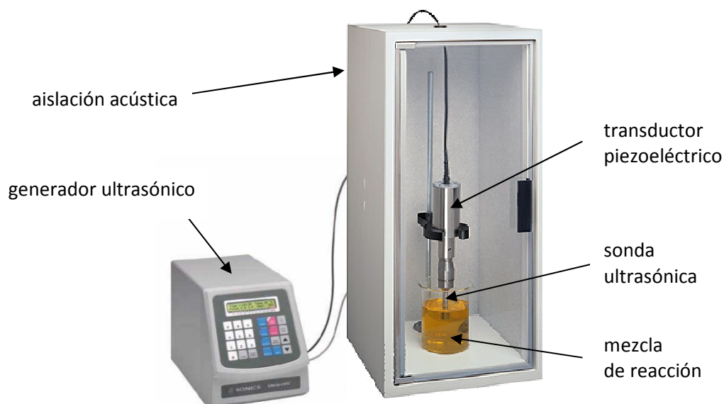
Figura 14: Transductor piezoeléctrico ultrasónico.
