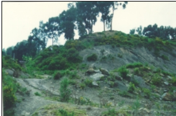
Fotografía 3.4. Disposición desordenada de materiales estériles de la cantera de explotación propiedad de Tubos Moore, al fondo se aprecia un talud conformado por arcillolitas y areniscas de la Formación Bogotá sin reconfiguración final de los taludes.
