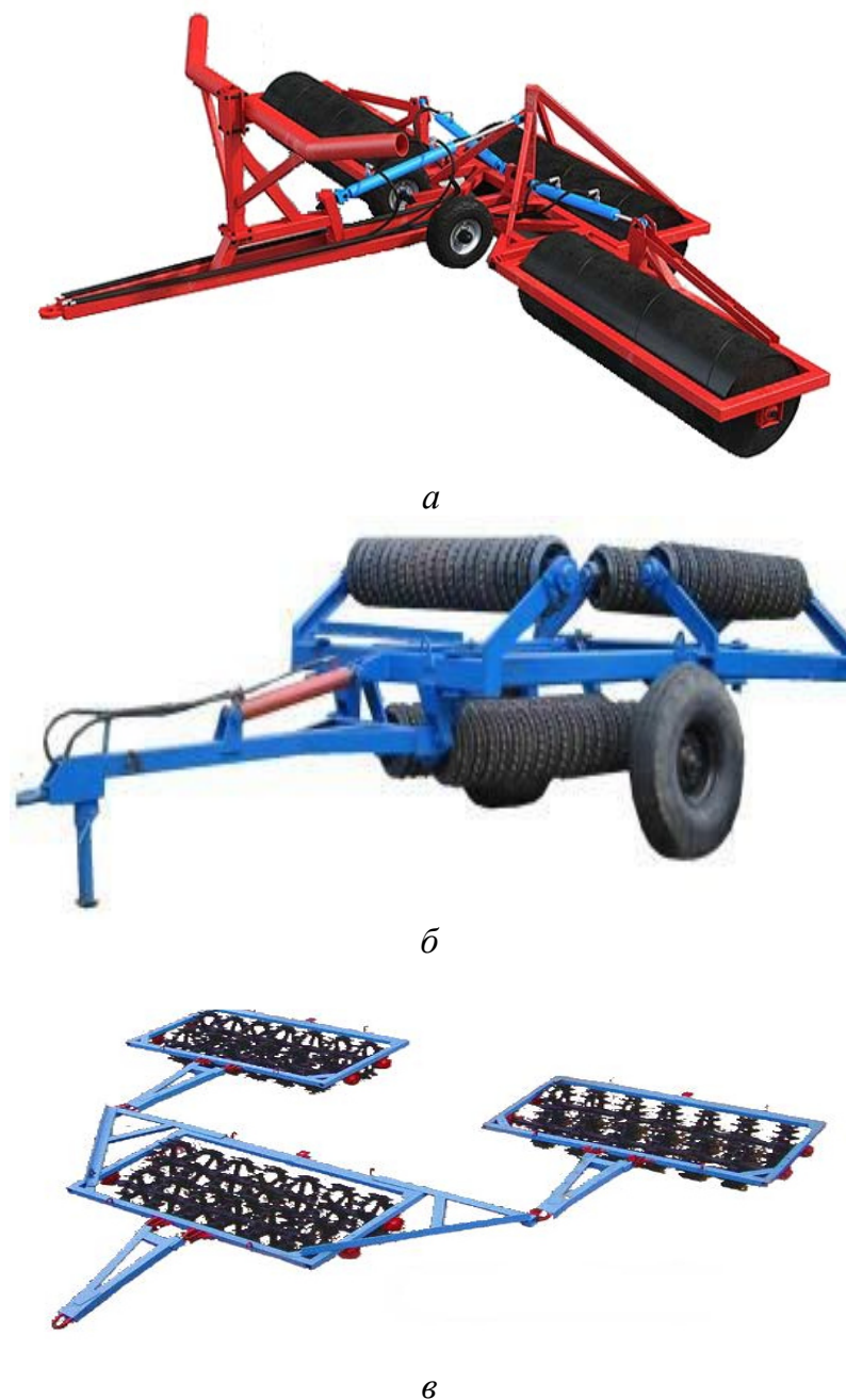
Рис. 1.18. Катки: а – водоналивной; б – каток зубчато-кольчатый; в – каток кольчато-шпоровый
