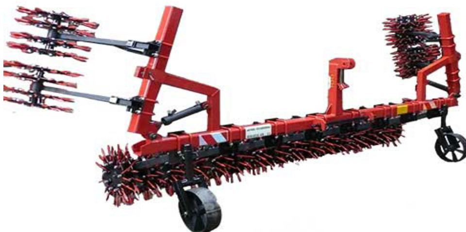
Рис. 1.15. Игольчатые орудия для обработки почвы: а – борона-мотыга ротационная; б – борона ротационная кольчатая (БРК-5,6)
