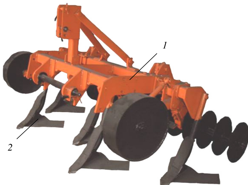
Рис. 1.6. Плуг с почвоуглубителем: 1 – корпус; 2 – почвоуглубитель
