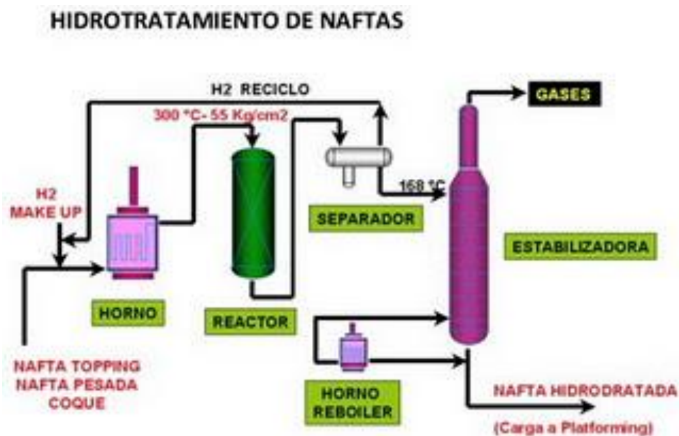
Figura 3.13.- Esquema básico de una unidad de hidrodesulfuración.
