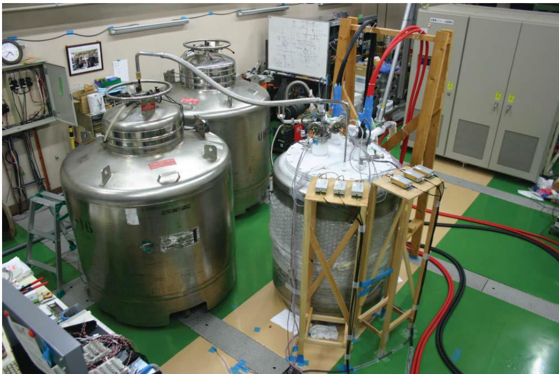
Fig.11. Imagen de un SME a la derecha. Equipo de refrigeración criogénica a la izquierda
