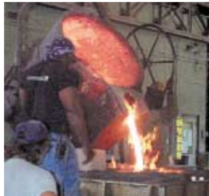
Günümüzde dökme demir fabrikalarının fırınlarında topraklaşmış maden filizleri (demir oksitler), kok kömürü yardımıyla 2000°C'nin üzerinde, konverterde oksijen etkisi altında ve hurda katılmasıyla ham çeliğe dönüştürülür.
