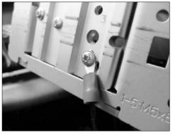
Ground wiring on the source (black wire on beam). Cancel echo effects and parasitic interference. Câblage de la masse sur auto-radio (fil noir sur faisceau). Supprime les effets échos et les bruits parasites.
