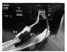
N°1: Plugged N°2: Plugged N°3: Not Plugged N°1 : Connecté N°2 : Connecté N°3 : Non connecté
