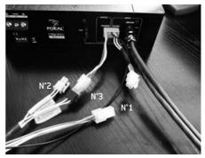
N°1:Not Plugged N°2: Not plugged N°3: Plugged N°1 : Non connecté N°2 : Non connecté N°3 : Connecté
