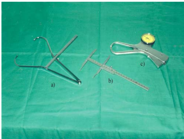
Fig. 4.3. a) Compás de espesor, b) Glissier y c) calibrador.
