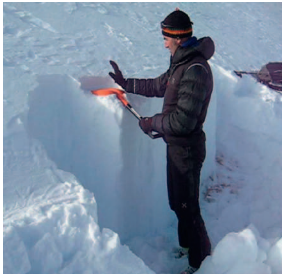
■ Esecuzione del test di stabilità "Extended column Test".
