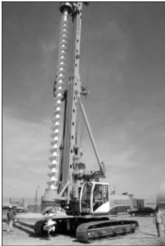
Рис. 3.3. Метод "полого шнека"
