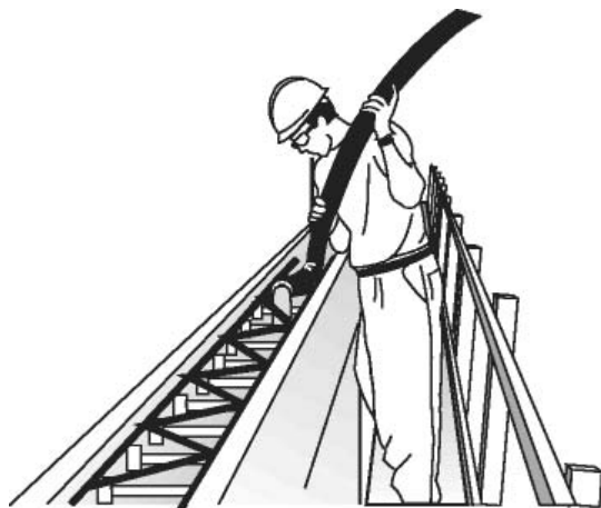
Рис. 7.45. Укладка бетона с подачей бетононасосом 2-го яруса бетонирования
