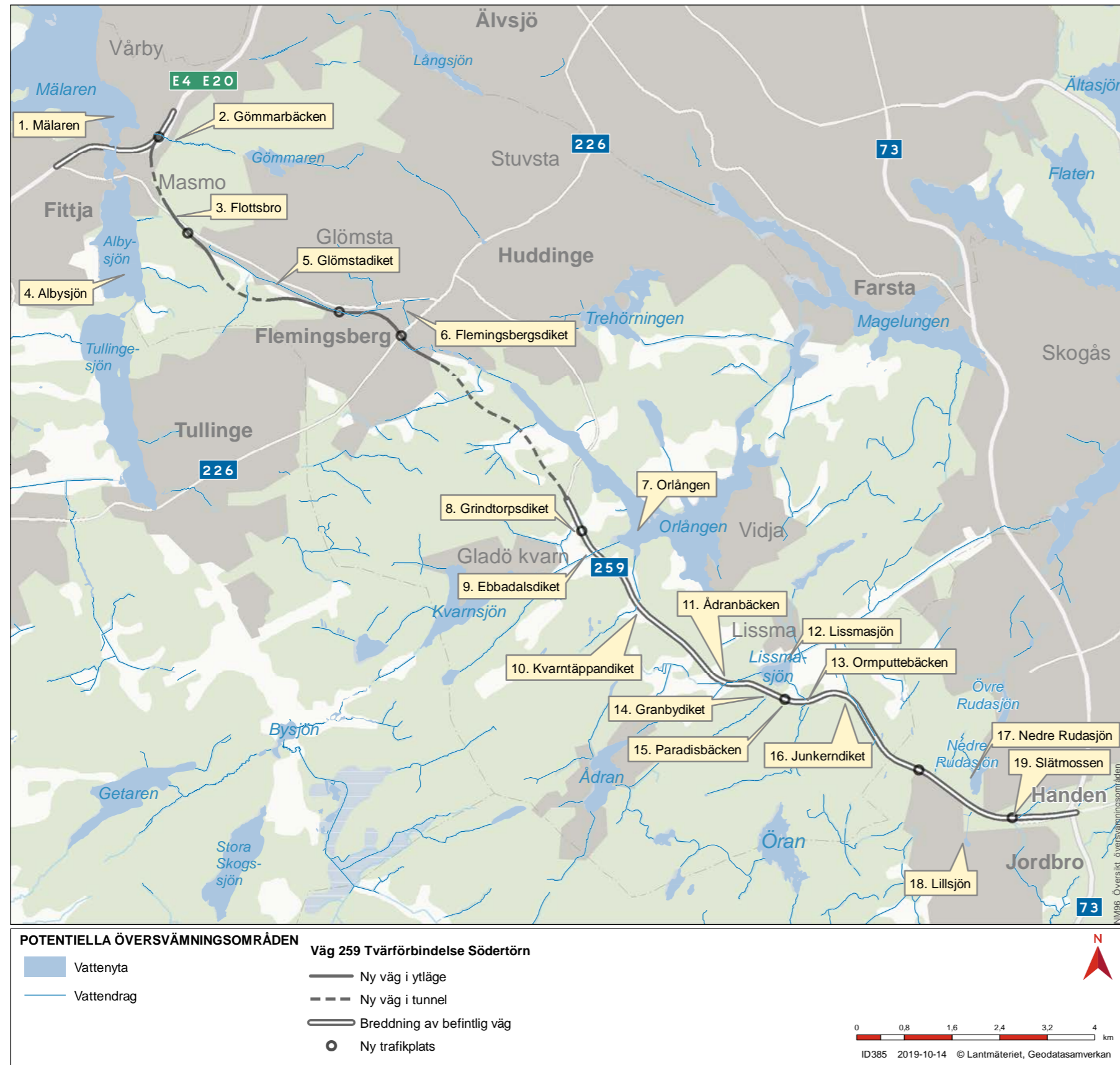
Figur 8.7. Potentiella översvämningssområden längs väg 259 Tvärförbindelse Södertörn.
