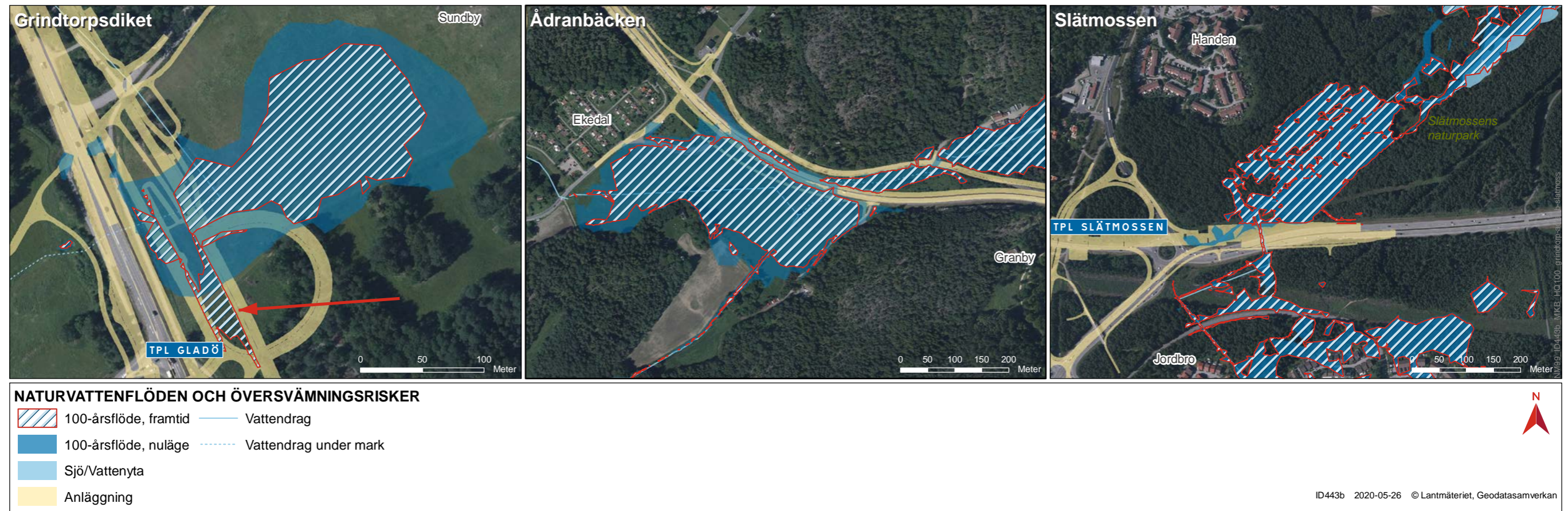
Figur 8.6. Jämförelse mellan potentiella översvämningsområden i nuläget och i en framtid med en utbyggd tvärförbindelse vid ett 100-årsflöde vid Grindtorpsdiket, Ådranbäcken och Slätmossen. Den röda pilen vid Grindtorpsdiket/trafikplats Gladö pekar mot det nya område som kan översvämmas med väg 259 Tvärförbindelse Södertörn utbyggd vid ett framtida 100-årsflöde jämfört med nuläget.
