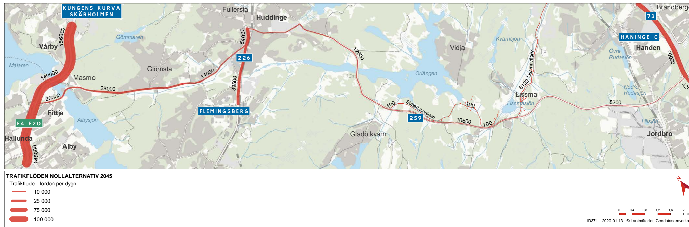
Figur 9.1. Figuren visar 2045 års trafikflöden i nollalternativet på befintlig väg 259 och anslutningen till E4/E20. Trafikflödena är baserade på årsmedeldygn vilket är ett genomsnitt av trafik, i båda köriktningar, under alla årets dagar inklusive helger och semestertider.
